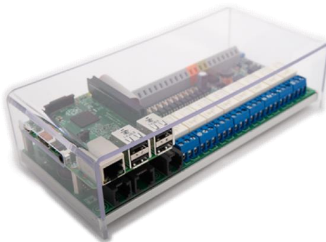
Figura 4 – Placa de expansão para transformar um módulo Raspberry Pi em um CLP.
