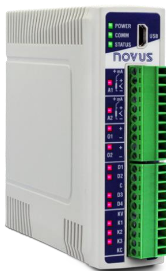
Figura 7 – Controlador Lógico Programável DigiRail NXprog . Fonte: NOVUS, 2019
