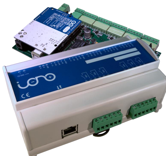
Figura 8 – Controlador Lógico Programável da família Iono . Fonte: SFERALABS, 2019
